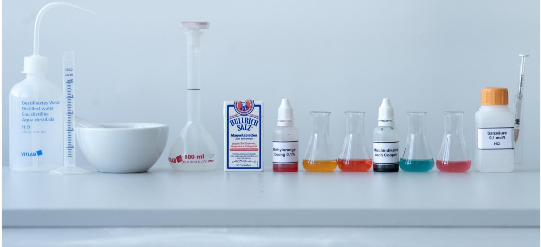
Säure-Base-Titration zur Bestimmung des Natriumhydrogengehalts
