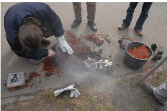
Das Gussteil wird aus der Form gestoßen
