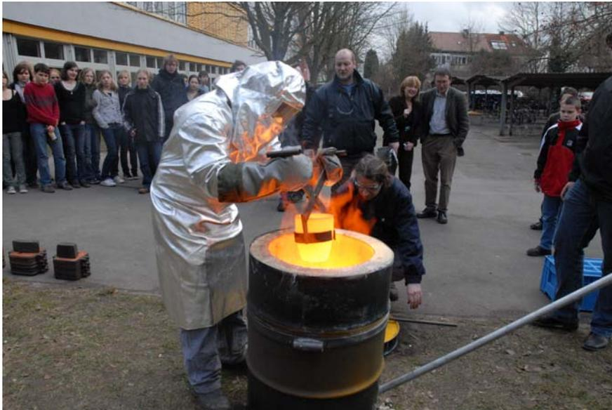
Der Tiegel wird mit Wärmeschutzkleidung aus der Glut entnommen
