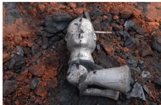
Gussteil mit Anguss- und Lüftungskanal
