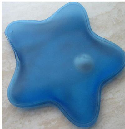
1. Kannst Du jetzt erklären, wie die Handwärmer funktionieren (das runde Teil in der Mitte ist ein Stück Blech, das durch Knicken die Kristallisation auslöst) und wie sie wieder "aufgeladen" werden.
