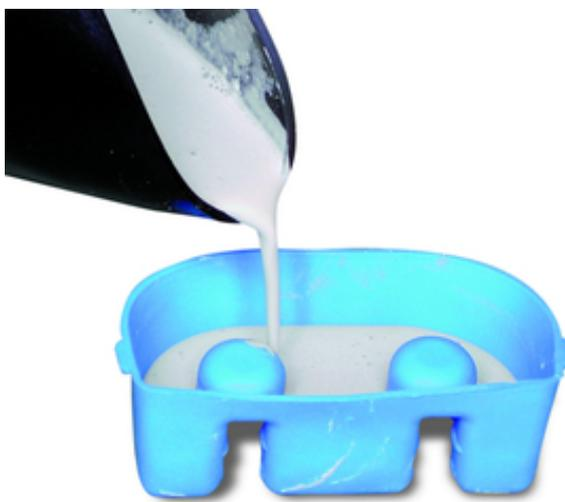
Abb. 1: Gießen der flüssigen Gipsmasse in die Silikonform
