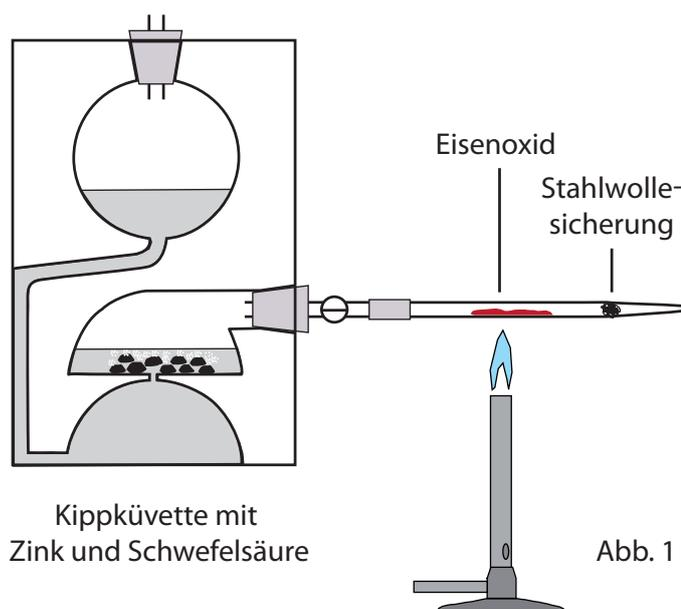
Nach dem Schließen des Zweiwegehahns wird der Brenner abgestellt und die magnetischen Eigenschaften des Reaktionsproduktes getestet.
