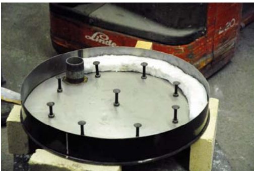
Der Deckel wird isoliert
