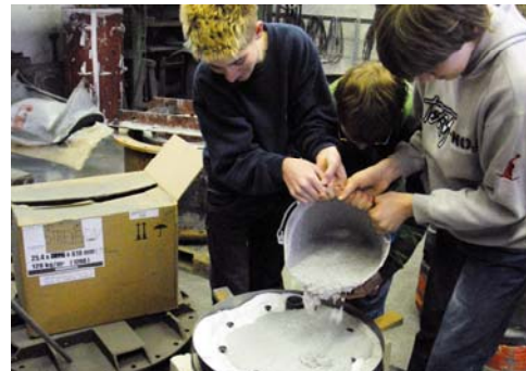
Der Deckel wird mit Mörtel ausgegossen
