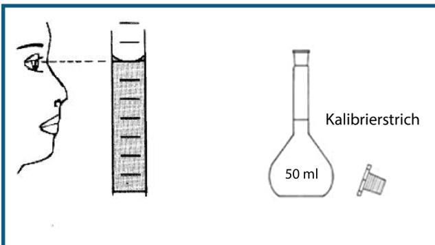
6. Verschließe den Messkolben mit einem Stopfen und drehe den Kolben mehrmals über Kopf, damit sich das Zitronensäurepulver komplett löst und die Lösung gleichmäßig durchmischt wird.
