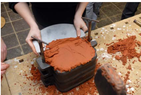
Überschüssiger Formsand wird abgezogen
