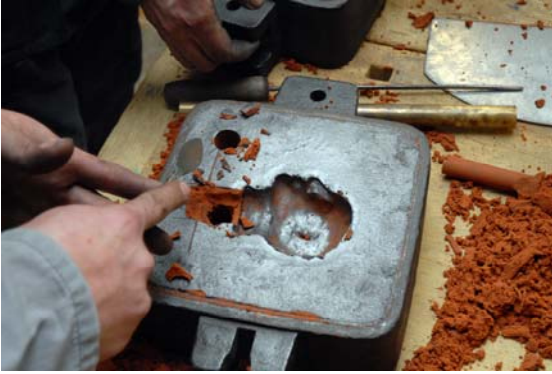
Arbeit am Eingusskanal
