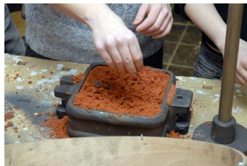
Die Formkasten wird mit Formsand gefüllt
