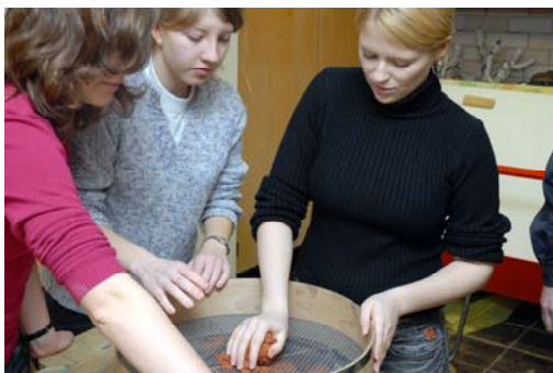
Der Formsand wird durch ein Sieb gestrichen
