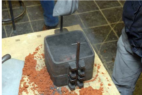
Graphit als Trennmittel wird aufgebracht
