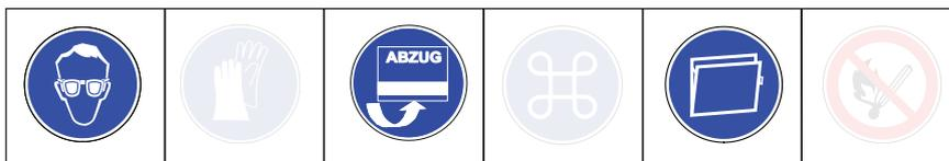
Schutzbrille tragen. Gefahr durch extreme Kälte. Kontakt mit flüssigem Stickstoff vermeiden. Beim Umgang mit flüssigem Stickstoff keine Ringe oder Uhren tragen. Wenn der Versuch als Schülerübung durchgeführt wird, auf gute Lüftung achten oder im Abzug arbeiten. Das Gas verdrängt in geschlossenen Räumen die Luft. Erstickungsgefahr. Reiner Sauerstoff ist brandfördernd, allerdings sind die Mengen so gering, dass keine Gefahr davon ausgeht.
