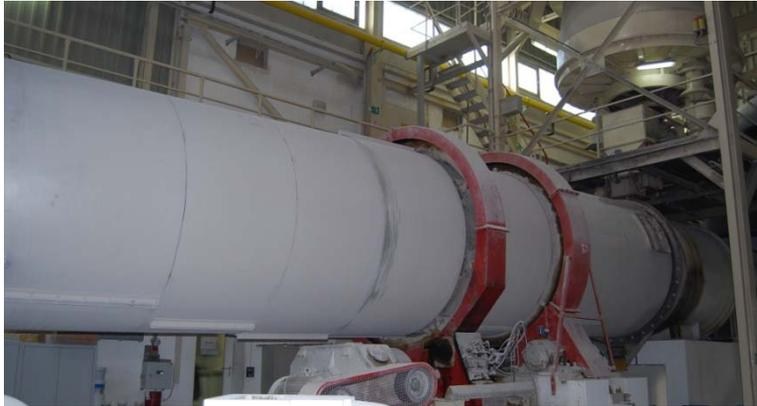
1. Im Drehofen wird das Dihydrat zum Halbhydrat
