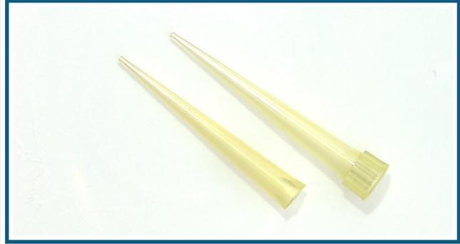
Die gelben Pipettenspitzen werden direkt unter dem Wulst mit einer Schere abgeschnitten, dann passen sie sehr gut auf die Spritze. Die Spritze zuerst luftblasenfrei füllen, dann die Spitze aufsetzen und jetzt erst auf Null einstellen. Die Pipettenspitze muss komplett mit Flüssigkeit gefüllt sein.
