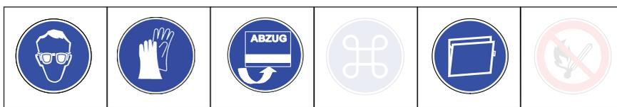
Schutzbrille tragen. Gefahr durch extreme Kälte. Als Kälteschutz Lederhandschuhe tragen. Kontakt mit flüssigem Stickstoff vermeiden. Beim Umgang mit flüssigem Stickstoff keine Ringe oder Uhren tragen. Auf gute Lüftung achten oder im Abzug arbeiten. Das Gas verdrängt in geschlossenen Räumen die Luft. Ersticken-gefahr.
