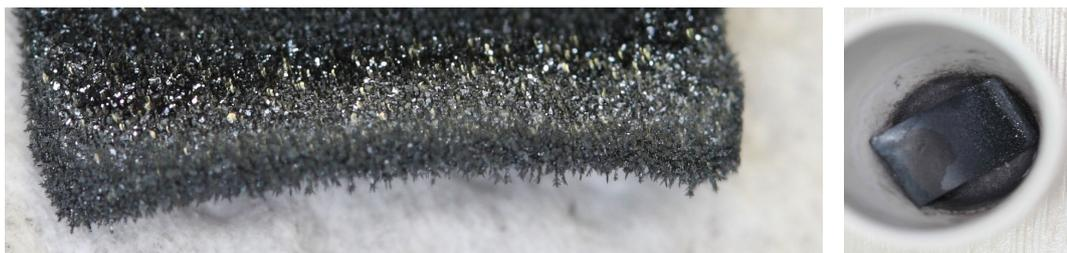
Links: Silbersulfidkristalle in starker Vergrößerung ( $\text{Ag}_2\text{S}$ )
