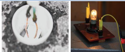
Prüfen der elektrischen Leitfähigkeit des Reaktionsproduktes
