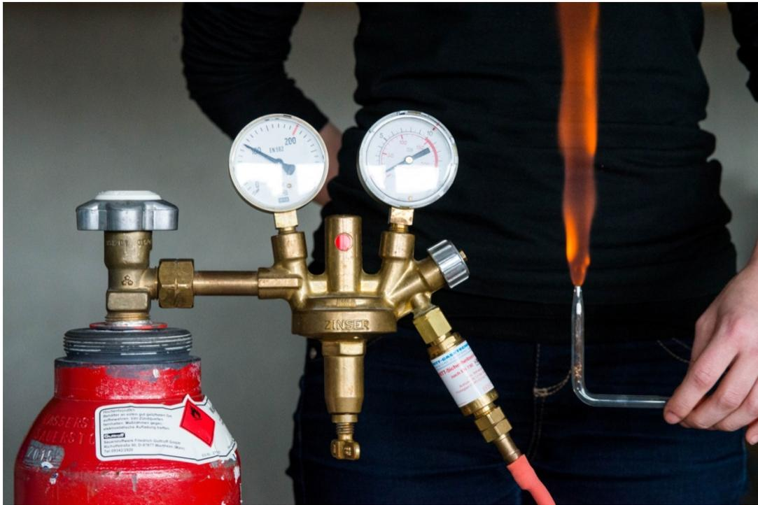
Rückschlagsicherung: Profi- und Selbstbauversion
