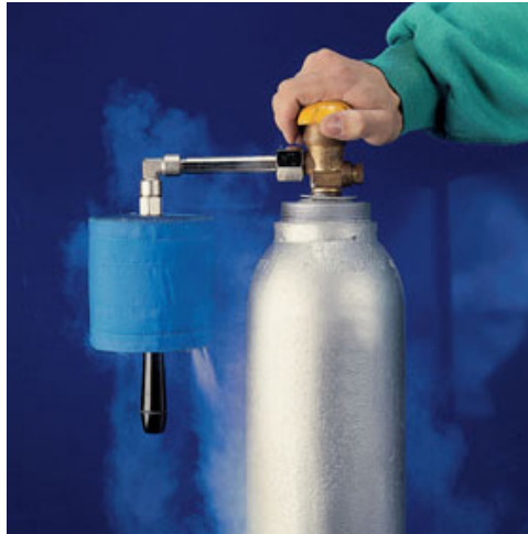
Abb. 1. Herstellung von Trockeneis mit dem Snowpack - Aufsatz und einer Steigrohrflasche (Bildquelle: LD-Didactic)
